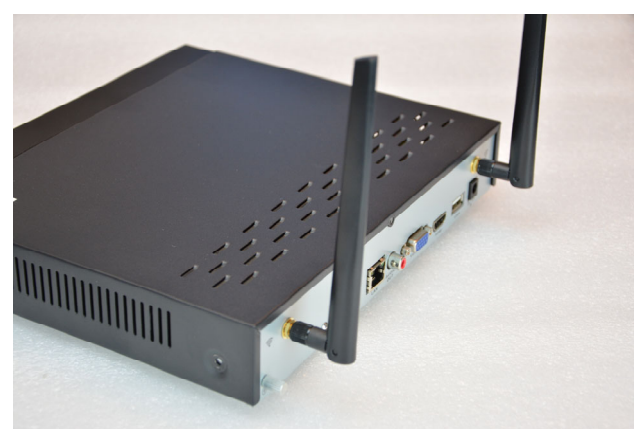
Richiudi il coperchio e avvita le 2 antenne sul retro dell'apparecchio
