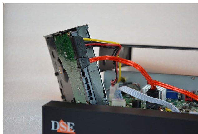
Collega l'hard disk con i due cavi di alimentazione e dati che trovi all'interno
