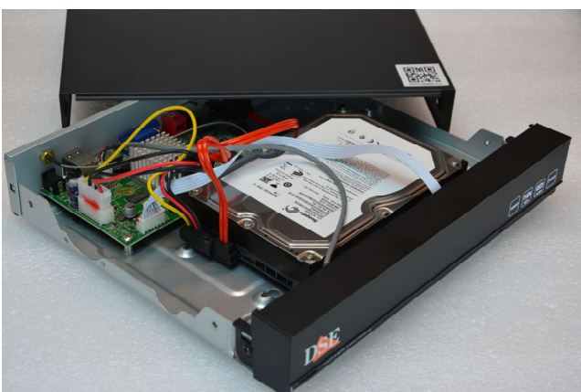
Fissa l'hard disk con le 4 viti fornite che si avvitano da sotto il videoregistratore
