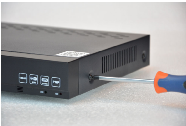
Rimuovi il coperchio svitando le 5 viti
